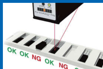
电子部件的重叠/漏装检测
